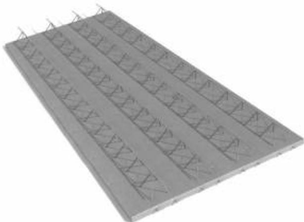
Nosiva konstrukcija izra?ena od master-panel plo?a zapravo se sastoji od tankih, filigranskih predgotovljenih elemenata i betona izvedenog na licu mjesta. Po pitanju ponašanja i dimenzioniranja, potrebno ju je tretirati kao monolitnu armirano-betonsku konstrukciju. Konstrukcija može biti nosiva u jednom, ali i u dva smjera. Može se primijeniti i kod nosivih zidova i kod zgrada s nose?im gredama.
